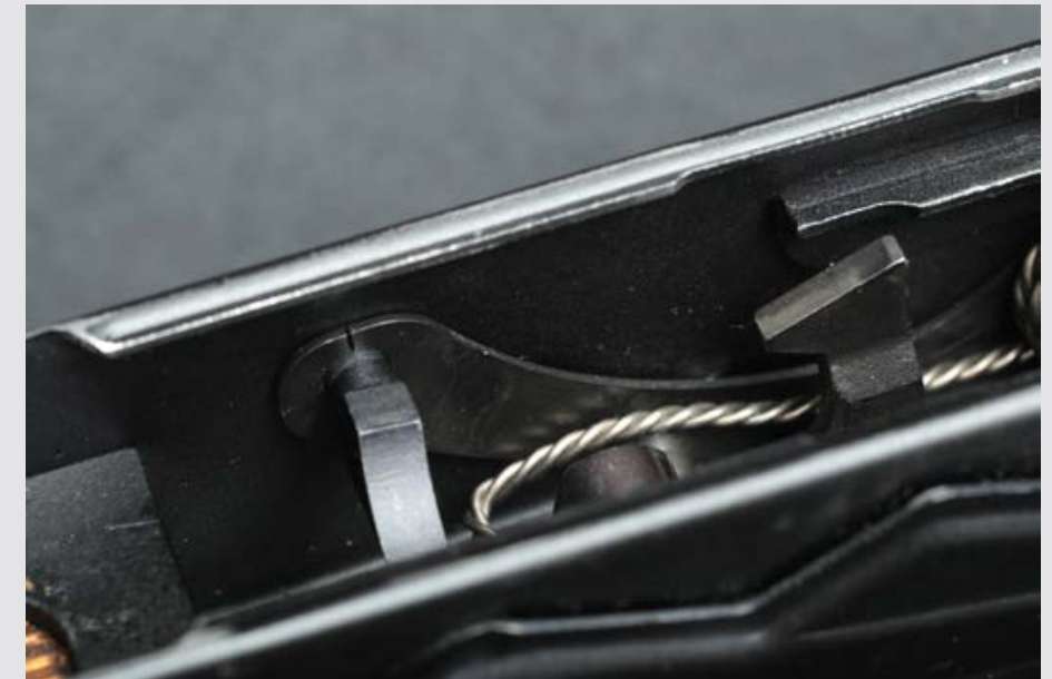
Diese Bleche sind empfehlenswert, wenn man einen AK-Matchabzug im Griffstück montiert, denn sie erleichtern Wartung und Pflege.
