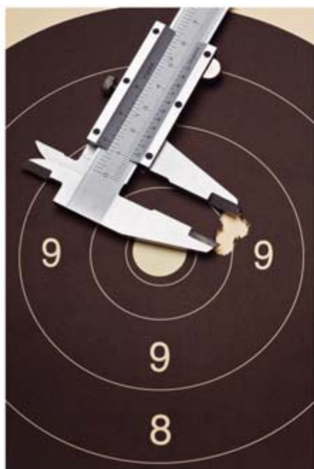
Erster Durchgang mit der ERA TAC Schnellspannmontage, Schußbild: 12 mm. Zweiter Durchgang, Streukreis: 10 mm (4 Schuß) beziehungsweise 17 mm (5 Schuß).
