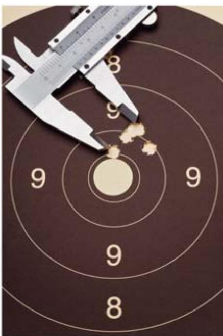
Im ersten und zweiten Durchgang konnten wir mit der ERA TAC Schraubmontage Streukreise von 17 mm produzieren.
