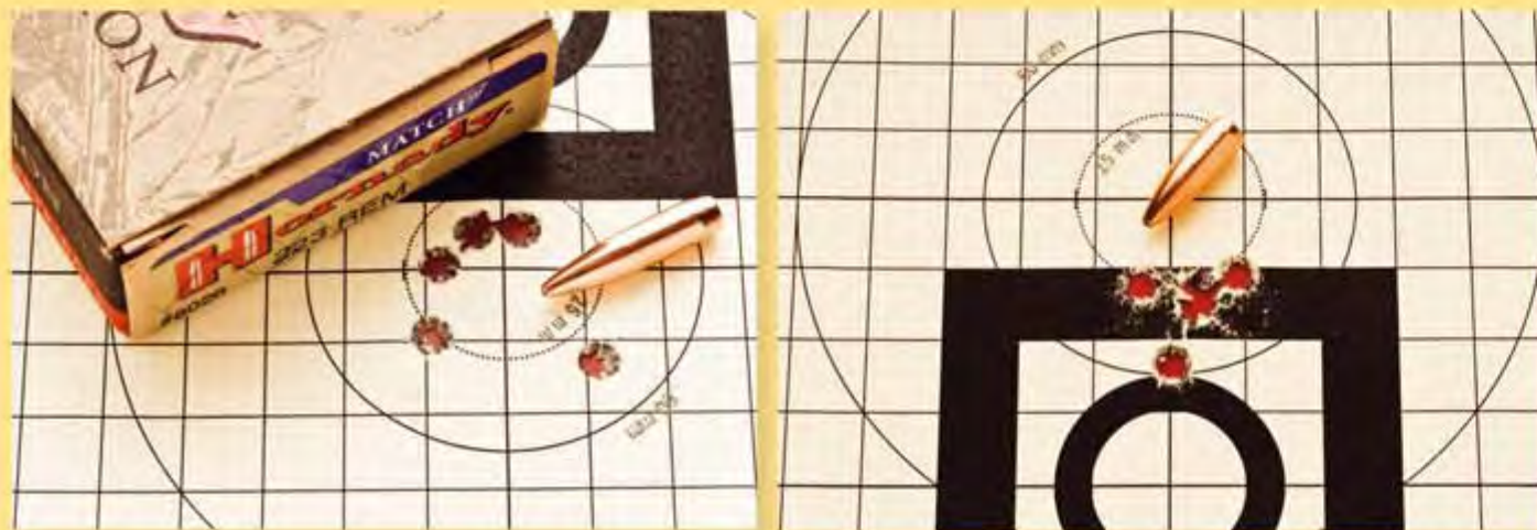
Die besten Streukreise mit Fabrikmunition: 17 mm Streukreis mit der 53 Grains Hornady HP W/C des kurzen AR-15 (links) und 23 (19) mm mit der 75 Grains Hornady BTHP Match des langen AR-15 (rechts).
