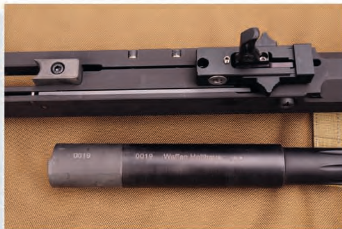
Wie bei einem Bullpupsystem üblich, gibt es eine lange Übertragungsstange zwischen Abzugseinheit und Schlagbolzen, worunter die Abzugskultur der DTA SRS Gewehre aber nicht leidet.
