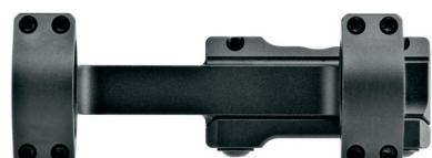
Oben: Rotierende Gesamtansicht der neuen ultraleichten Blockmontage. Diese kann für die Durchmesser 25,4 mm, 30 mm, oder 34 mm geliefert werden. Das Gewicht beträgt dann 146 g, 147 g oder 148 g. Grundsätzlich ist keine MOA-Vorneigung gegeben. Die Blockmontage verfügt über keinen Klemmmechanismus, sondern über Torxschrauben. Die Montage kann bis hoch zu .50 cal eingesetzt werden (12,7 mm x 99).
