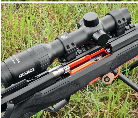
Oben: Der Schnellverschluss von Recknagel (ERA LOC) fasst den neuen Titanschalldämpfer Recknagel ERA Silencer STI 3D. Unten: Das Magazin ist in orange gehalten und nimmt fünf Patronen auf.
